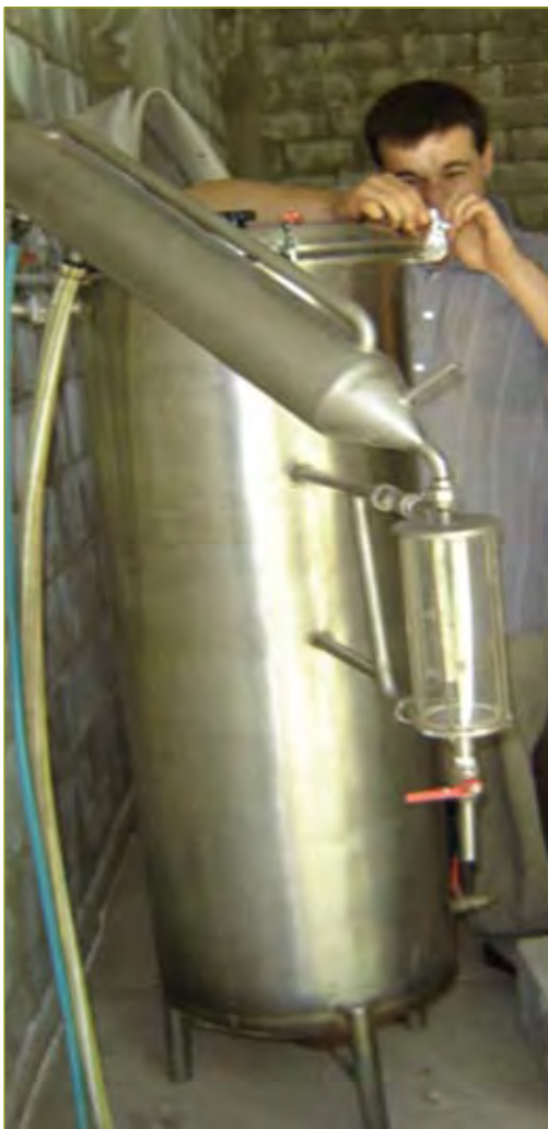
Destilador: máquina utilizada para extraer aceites esenciales.
